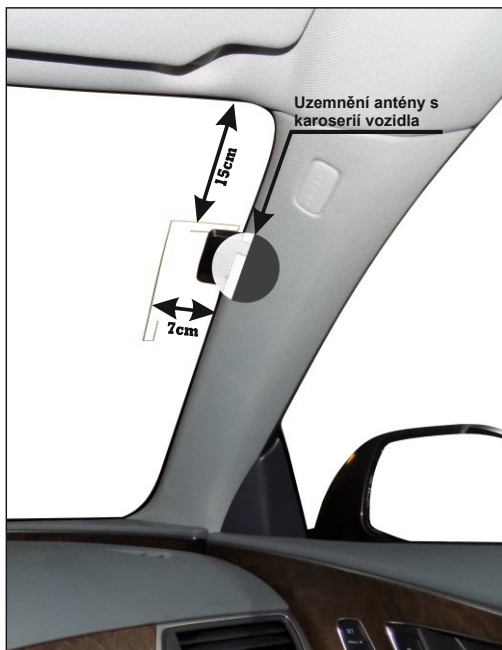
Příklad montáže antény DAB / DAB +
